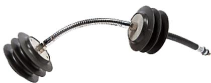
Le système modulaire pour l'inertage est destiné à isoler rapidement le volume à inertier de part et d'autre du joint à souder afin d'éviter la corrosion lors du soudage de tubes et raccords de tuyauteries en aciers ferriques et austénitiques.
