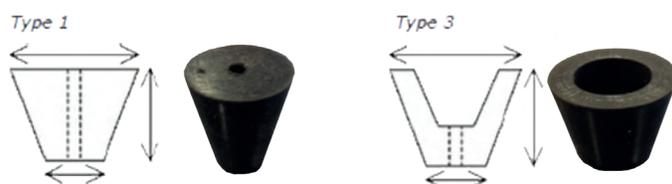
Les bouchons coniques en silicone sont parfaitement adaptés pour obturer tout type de tubes dans des applications d'inertage ou autre du Ø10 à 100mm. Ils sont utilisables sur une plage de température de -60 à + 340°C. Le trou central permet d'envoyer du gaz dans le tube ou il peut être bouché en cas de besoin à l'aide du raccord à obturateur réf. 1557042.
