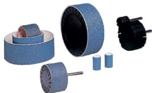
Les spirabandes sont faits de toile abrasive enroulée et collée sur un support coton. Ils sont destinés aux travaux sur métaux, cuir, verre, plastique et bois. Ils conviennent parfaitement au décapage des peintures, au nettoyage des surfaces et à l'ébarbage. Ils sont utilisés sur les outils électriques et pneumatiques, montés sur un mandrin spécial en caoutchouc de la bonne dimension.
