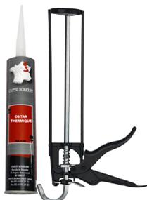
Mastic colle de jointage et d'étanchéité formulé spécialement pour les très hautes températures. Tenue de -40°C à +1500°C sans déformation. Température d'application : +5 à +40°C. Epaisseur min/max 5 à 15mm. Mise en service après 12 heures : une mise en chauffe progressive est conseillée. Ne pas utiliser en milieux humides.
