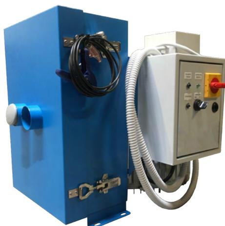
Livré de série avec une pince de démarrage automatique lors du soudage (câble de 10m)
